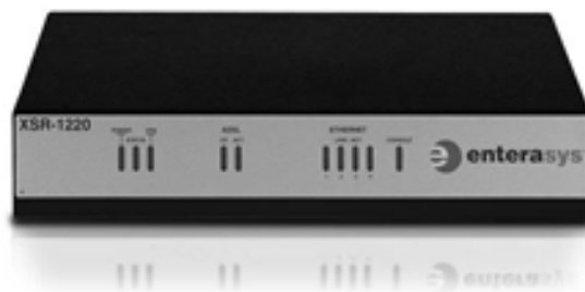
شکل ۷-۱: یک روتر کوچک که برای استفاده در شبکه‌های کوچک مفید است
