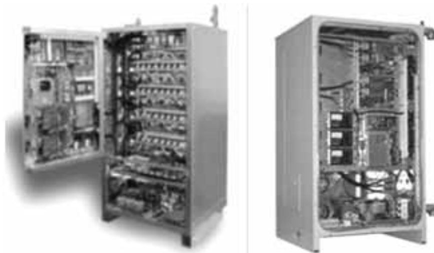
شکل (۱-۵): تجهیزات الکترونیک لکوموتیو
