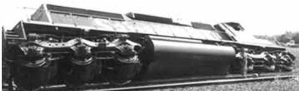
شکل (۸-۱): سبک قرارگیری مخازن سوخت و هوا در زیر شاسی لکوموتیو
