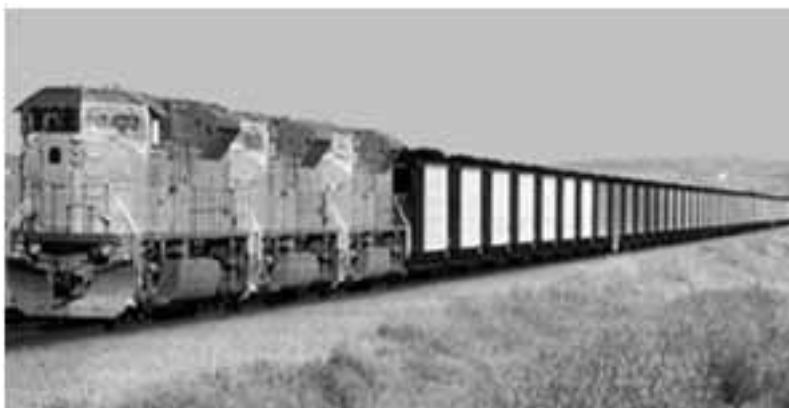
شکل ۱-۲: لکوموتیو باری دیزل الکتریک SD90MAC با توان کششی ۶۰۰۰ hp مجهز به ترکشن موتورهای AC ساخته شده در سال ۱۹۹۸ در آمریکا
