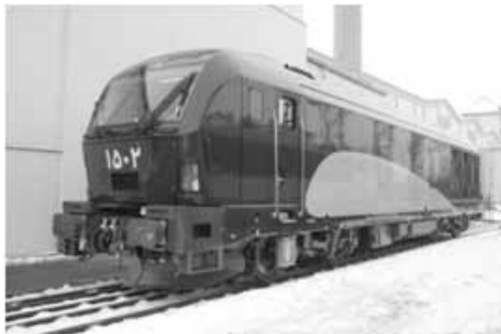
شکل ۱-۱: لکوموتیو دیزل الکتریک مسافری مدل ER24PC (ایران سفیر) ساخته شده توسط شرکت مپنا لکوموتیو تحت لیسانس شرکت زیمنس
