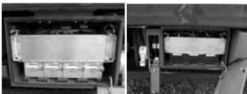
باتری استارت موتور دیزل (1×24V DC Approx. 170 Ah)
