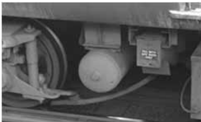
شکل (۱-۱): تصویر یک جعبه شن به همراه لوله‌ی شن‌پاش
